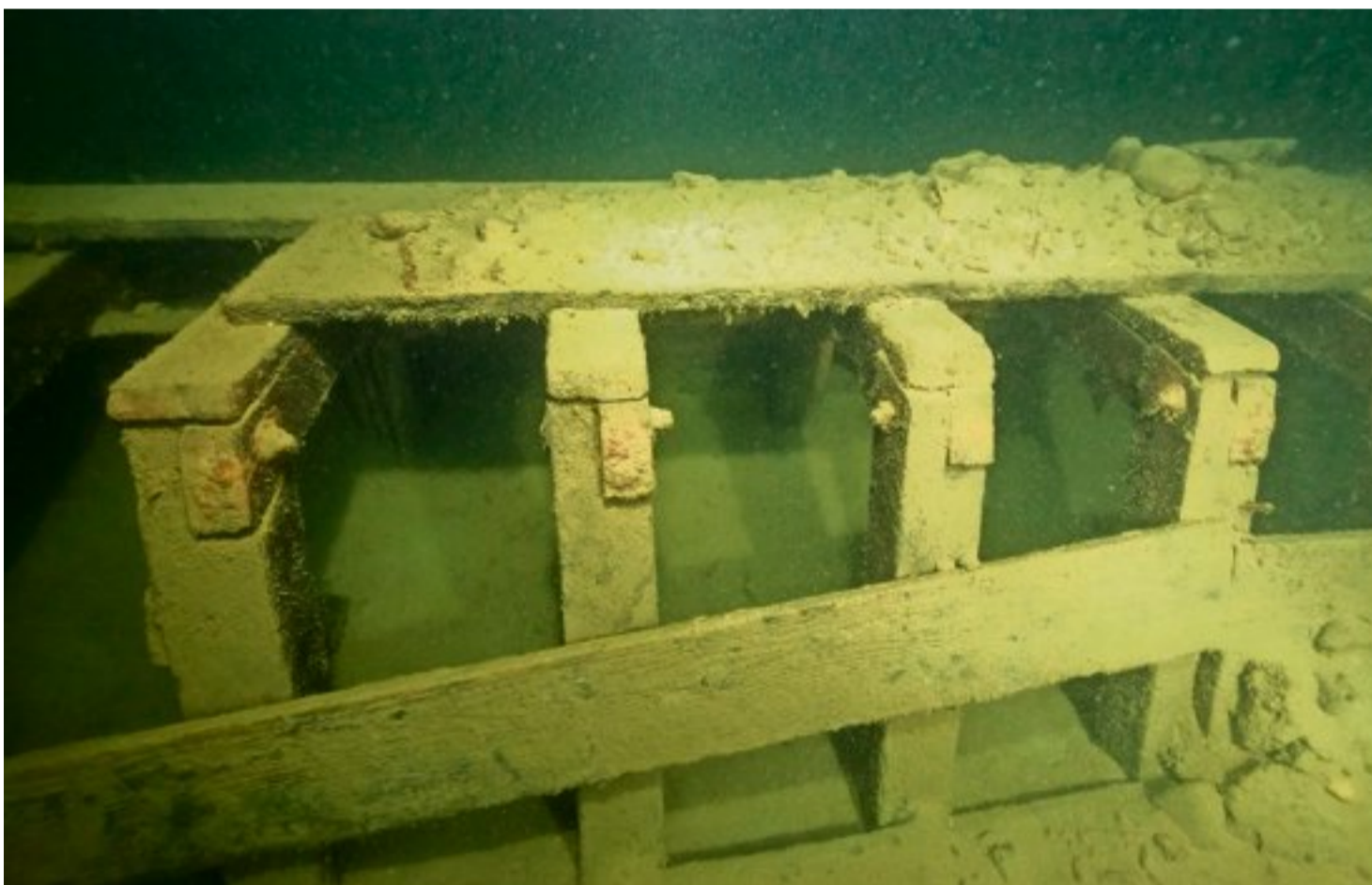
Einblick ins Gerippe des Wracks: Eine Holzkonstruktion zur Verstärkung des Laderaums ist noch deutlich erkennbar.
