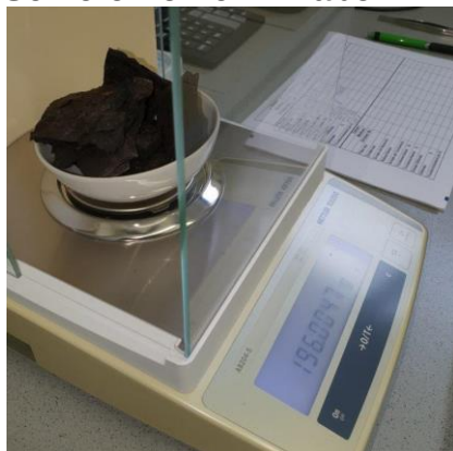
Labor Test der Schieferkohle aus dem Wrack vor Wädenswil
